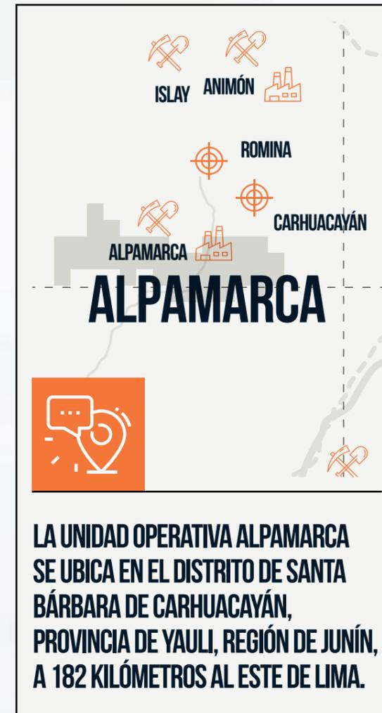
Esta unidad inició sus operaciones en abril del 2014 y está conformada por la mina subterránea de Río Pallanga (paralizada temporalmente), el tajo abierto Alpamarca, la planta concentradora Alpamarca (que cuenta con una capacidad instalada de 2,500 tpd) y el proyecto de expansión Romina.
